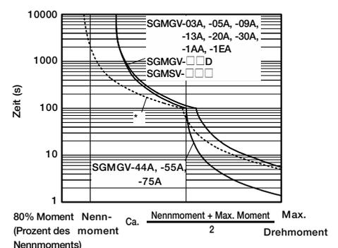
Anmerkung: Die oben genannten Überlastkenndaten garantieren keinen Dauerbetrieb mit 100 % oder mehr Ausgangsleistung. Setzen Sie einen Servomotor mit einem effektiven Drehmoment innerhalb des Dauerbetriebsbereichs der Drehmoment-Drehzahl-Kennlinien ein.
